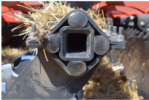
Система защиты из четырех полиуретановых эластомерных блоков, обеспечивающих отвод каждого диска в случае столкновения с препятствием
