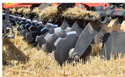
При большом количестве растительных остатков лучше работать дисками с большими зубьями
