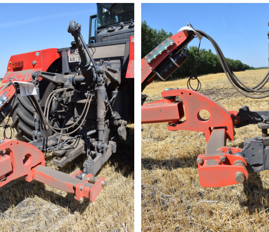
Сцепление за трехточечное устройство трактора уменьшает радиус разворота и переносит нагрузку на трактор
